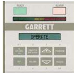
เครื่องตรวจค้นวัตถุโลหะ PD 6500i นั้นได้มีการติดตั้ง Access Control Panel เพื่อใช้สำหรับผู้ที่ได้รับอนุญาตในการ ตั้งค่าความถี่ในการตรวจค้น และการตั้งค่าอื่นๆ โดยมีการป้อน password ลงไปในเครื่องเพื่อป้องกันการไม่ให้ผู้ที่ไม่ได้รับอนุญาตแก้ไขข้อมูลต่าง ๆ
